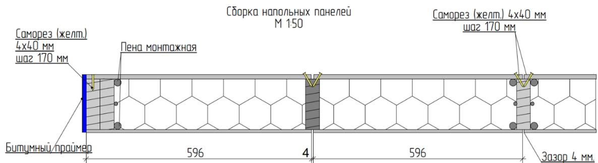
**Примечание:** саморезы 4х40 закручены в пиломатериал с отклонением от вертикали на угол 30 град.
